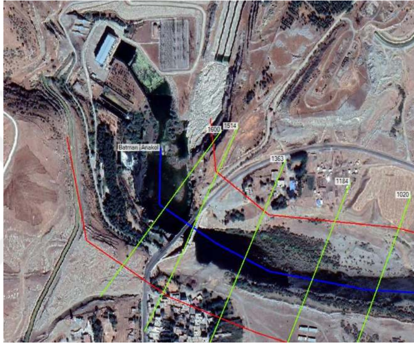
Şekil 4.19 Tek boyutlu taşkın analizi
