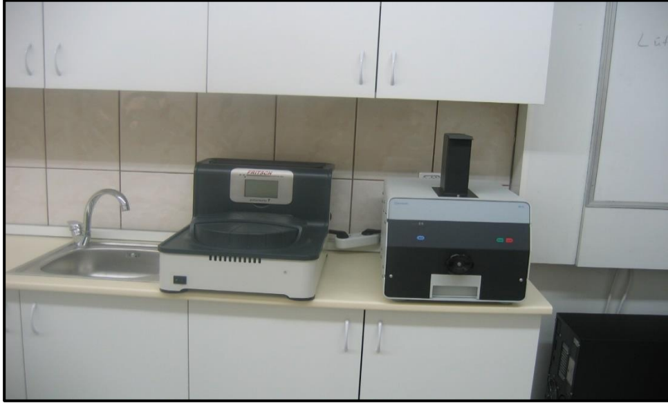
Şekil 3.20. Öğütme işlemi yapan bilyeli değirmen (MTA, 2018)
