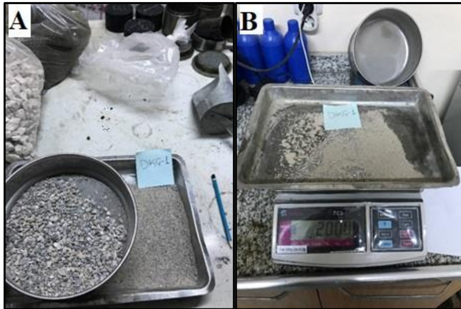
Şekil 3.9. 0-2 mm boyutundaki agrega numunesinin hazırlanması (A) gerekli miktar numune (B)
