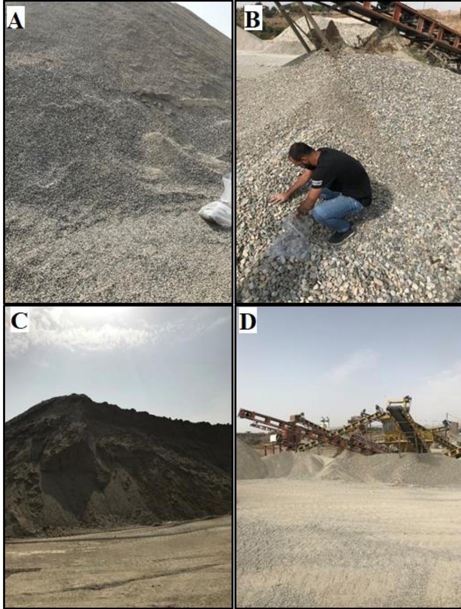
Şekil 6.52. Çayönü (Reşâdara) konkasörü-2 (DKÇ-2)' ye ait stok görüntüleri (A- 7-15 mm boyutlu agrega, B-doğal malzeme, C-yıkanmış kum, D-konkasörden genel görünüm)
