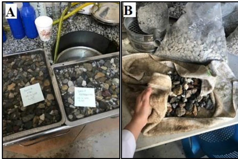
Şekil 3.5. Üstü su ile doldurulan (A) ve suda bekledikten sonra kurutulan numune (B)
