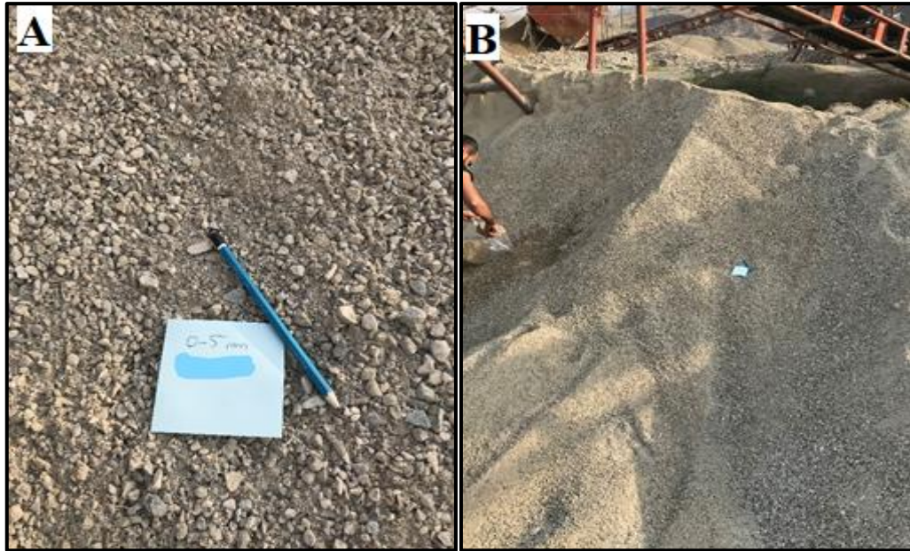
Şekil 6.70. Suçeken (Şikeftan) konkasörü (DHÇ-1)'ne ait 0-5 mm boyutlu agrega stoğu (A-yakın, B-uzak)
