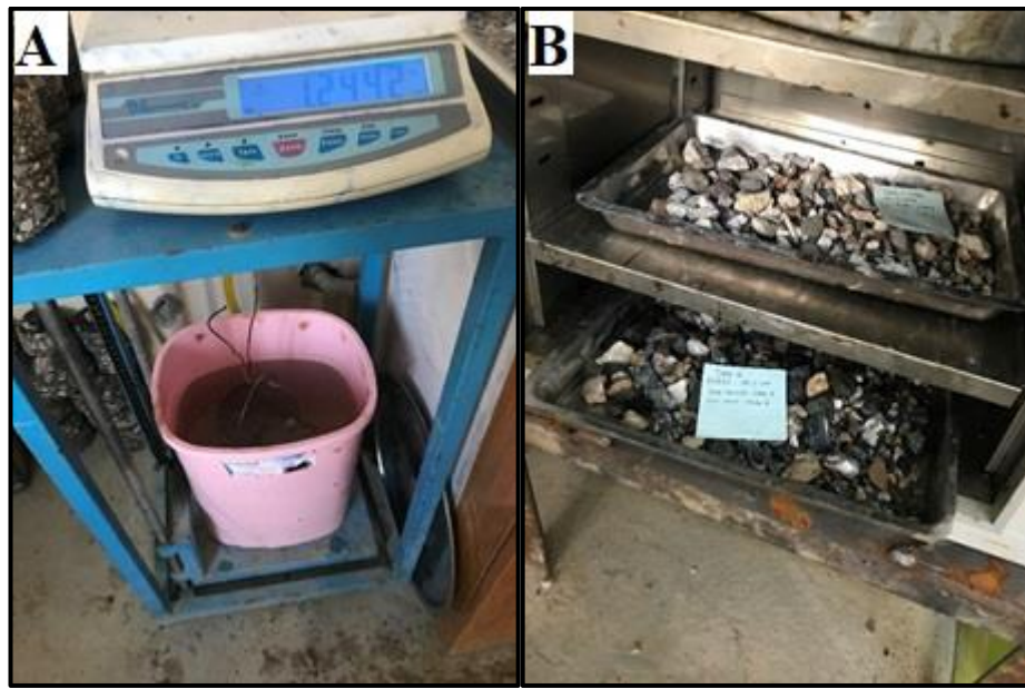
Şekil 3.6. Tel sepette suya daldırılan numune (A), etüve atılan numune (B)
