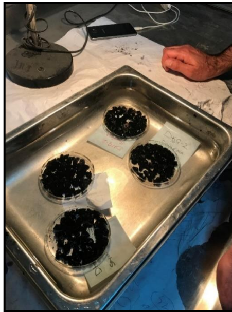
Şekil 3.13. Soyulma oranının ışık yardımıyla gözle incelenmesi
