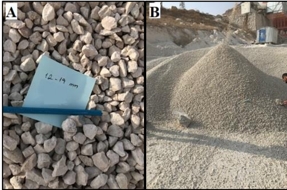
Şekil 6.41. Yeni Hasankeyf konkasörü (DHK-4)' ne ait 12-19 mm boyutundaki agregâ (A-yakın stok, B-uzak bant altı)
