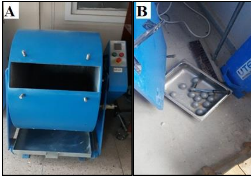
Şekil 3.2. Los Angeles parçalanma cihazı (A) ve bilyeleri (B)
