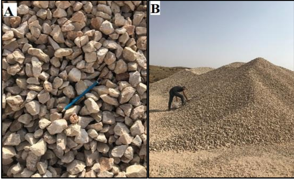
Şekil 6.46. Arıca (Kefri) konkasörü (DGK-1)' ne ait 19-25 mm boyutundaki agrega stoğu (A-yakın, B-uzak)
