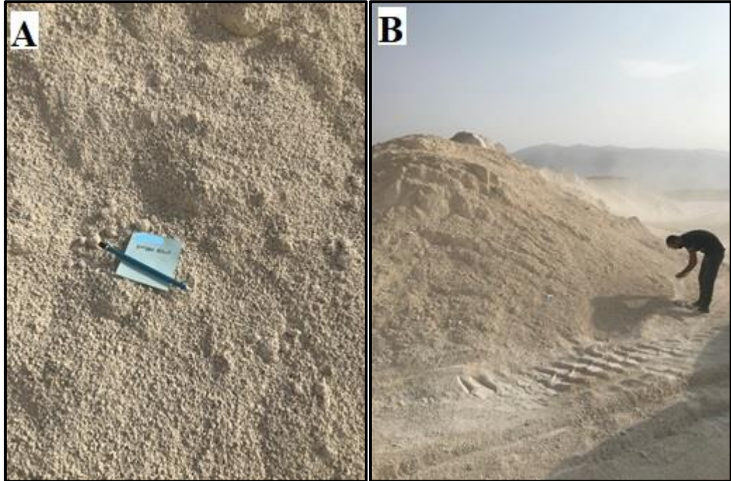
Şekil 6.39. Yeni Hasankeyf konkasörü (DHK-4)' ne ait 0-5 mm boyutundaki agrega (A-yakın, B-uzak)
