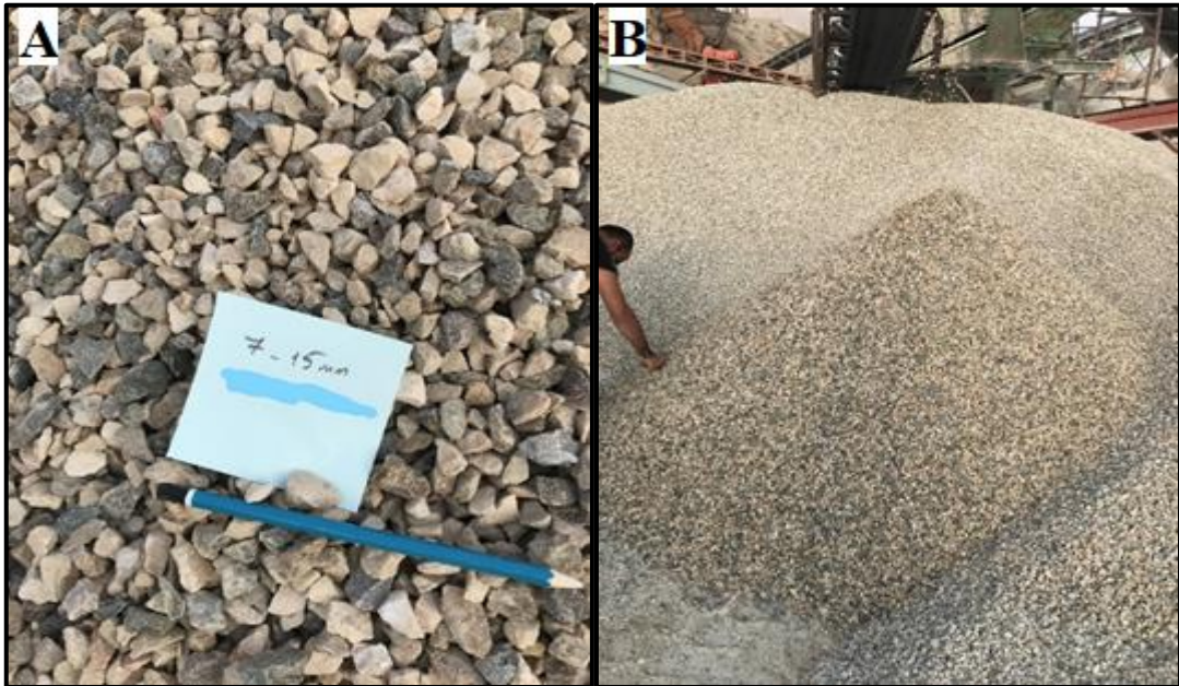
Şekil 6.76. Kesmeköprü (Kuriserpir) konkasörü (DHÇ-2)' ne ait 7-15 mm boyutlu agrega stoğu (A-yakın, B-uzak)
