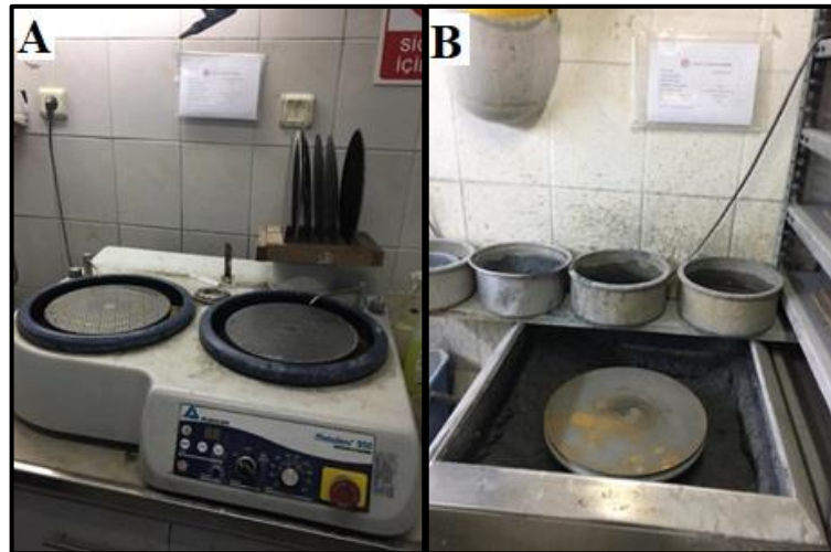
Şekil 3.17. Parlatma (A) ve aşındırma diskleri (B)
