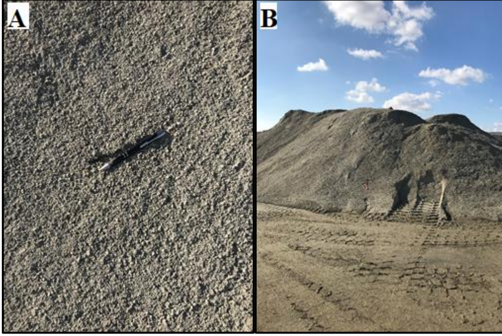
Şekil 6.63. Yediyol (Elkami) konkasörü-1 (DÇ-1)' e ait 0-7 mm boyutlu agrega stoğu (A-yakın, B-uzak)
