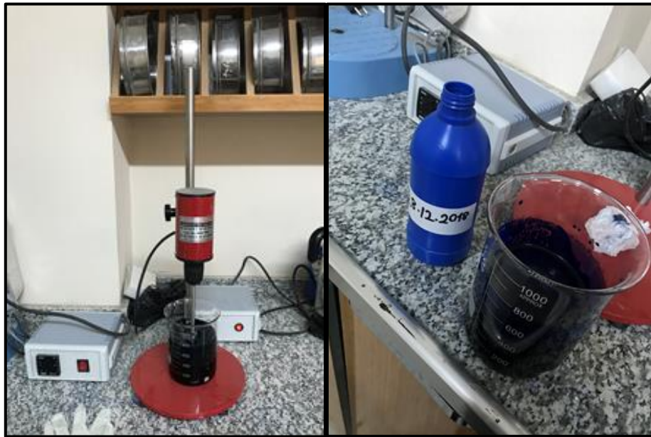
Şekil 3.8. Metilen boya çözeltisinin hazırlanması
