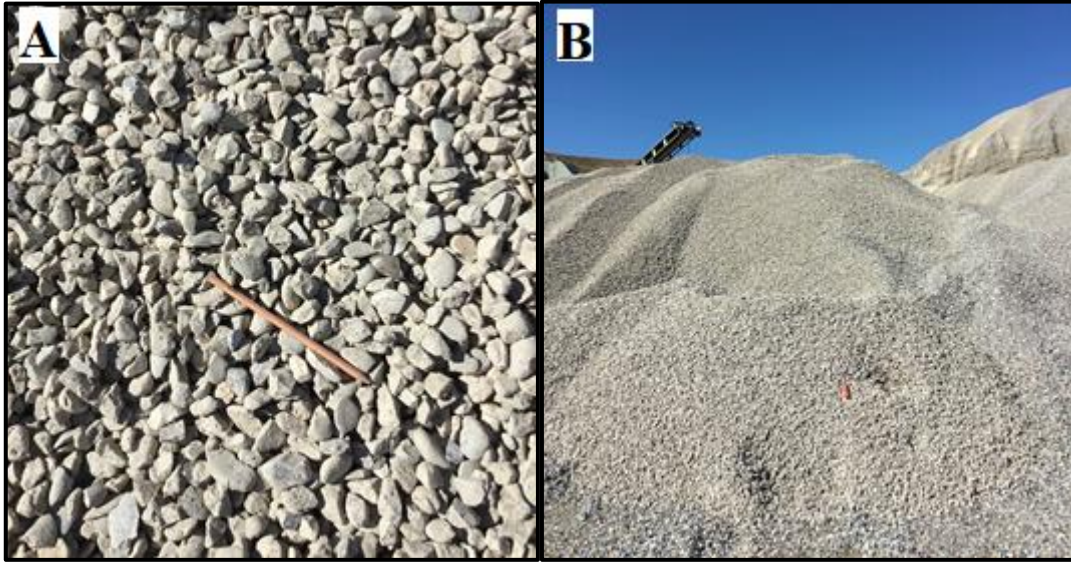
Şekil 6.60. Durucak (Bımır) konkasörü (DBÇ)' ne ait 7-15 mm boyutlu agreg a stok görüntüleri (A-yakın, B-uzak)
