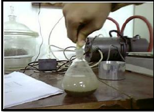
Şekil 4.2. Laboratuvar ortamında Doğal Birim Hacim Ağırlığı tayini ( http://netl.doe.gov santiyeci.blogspot.com ).
