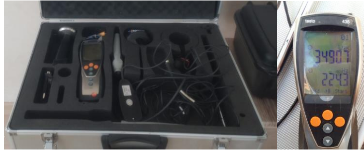
Şekil 2.9. TESTO 435 Hava Kalitesi Ölçme Sistemi (Hava Hızı ve Işık Şiddeti Ölçme)
