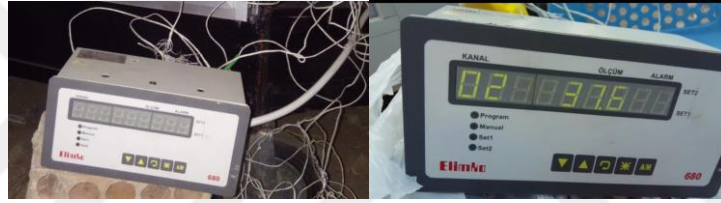
Şekil 2.8. Elimko E-680 sıcaklık ölçme sistemi
