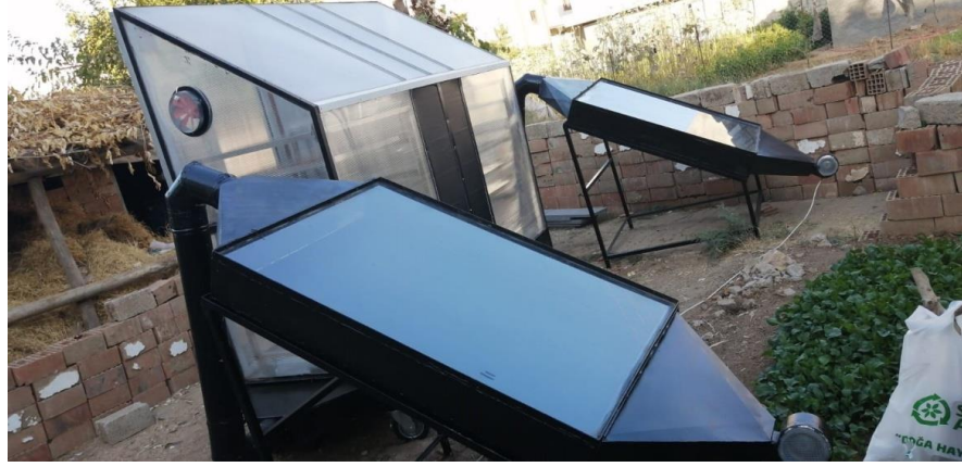
Şekil 2.3. Güneş enerjisi destekli enerji depolama sistemli tarımsal ürün kurutma sistemi fotoğrafı
