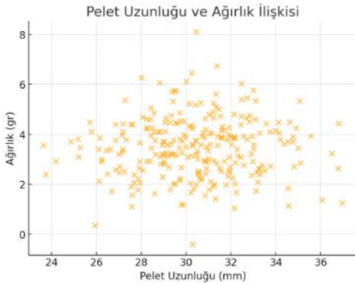
Şekil 4. 2 Çalışmalarda elde edilen peletlerin ağırlık ve uzunluk ilişkisini gösteren grafik.
