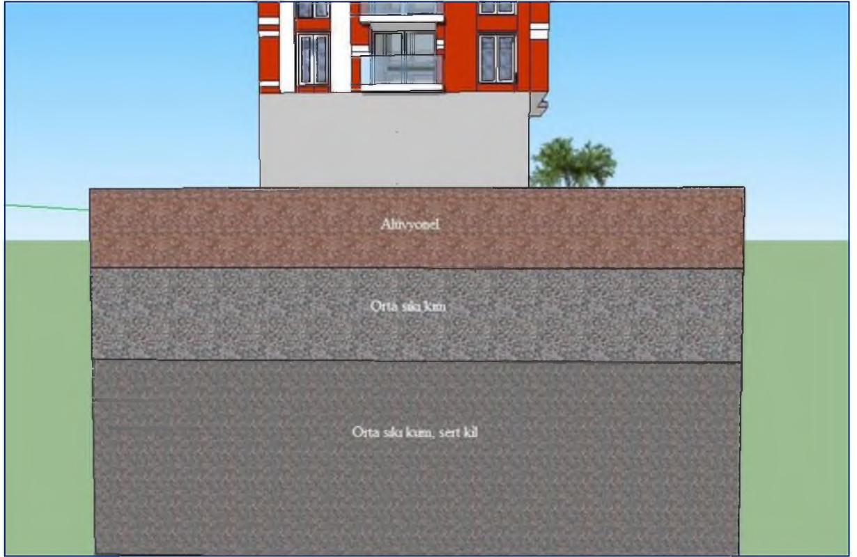
Şekil 4.12. Tilmerç mahallesi zemin tabakaları
