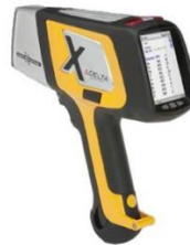
Şekil 3.34. Batman Üniversitesi Arkeometri AB Dalında kullanılan P-EDXRF
