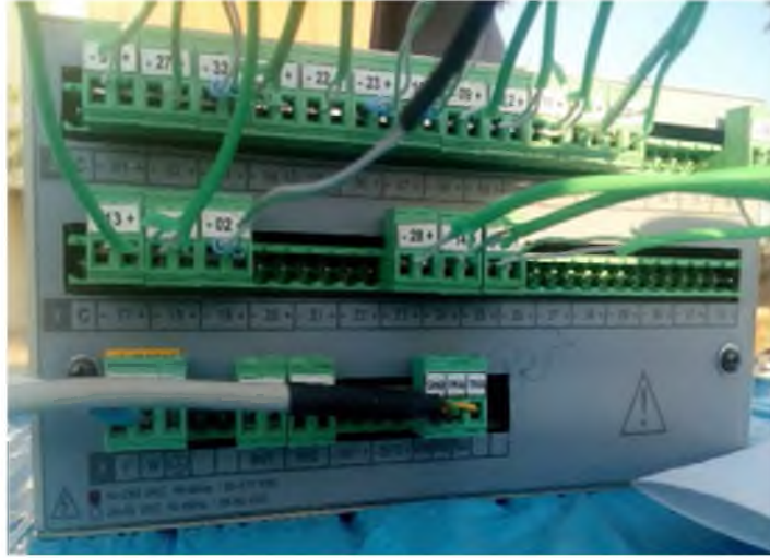
Şekil 4.10. Termokuplların dataloggera bağlantısı
