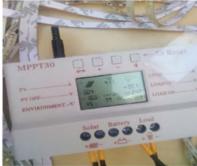
Şekil 4.11. MPPT30 cihazının bağlantısı
