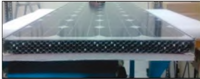
Şekil 3.21. PV modülünün arkasında kurulu petek fotoğrafı (Hussain,2013)
