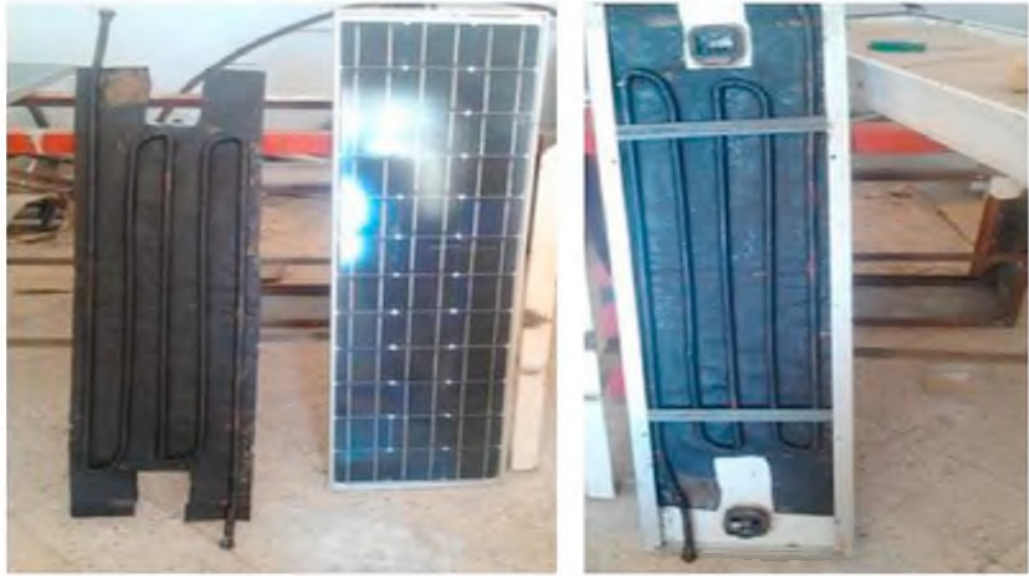
Şekil 1.8. PV modülünün arka yüzüne bağlı ısı değiştiricisi (Khelifa, 2016).
