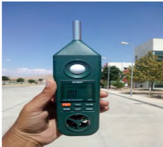
Şekil 4.3. Rüzgâr, sıcaklık, nem ölçen alet Anemometre
