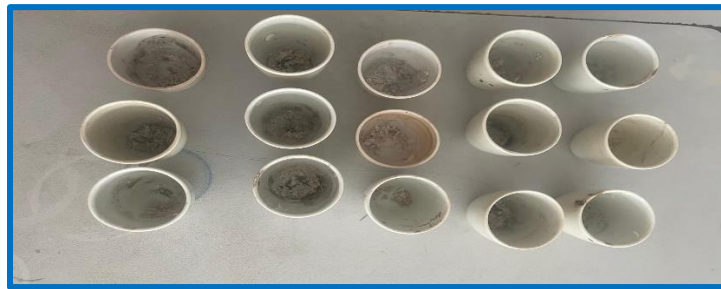
Şekil 3.6 Kül tayini sonucunda krezelerde kalan kül görüntüsü.
