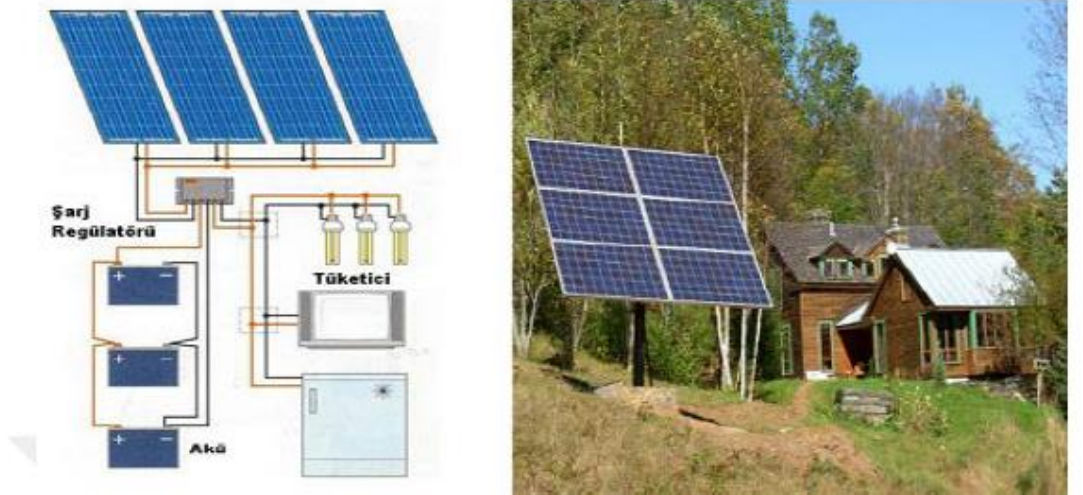
Şekil 2.28. Şebekeden bağımsız PV sistem
