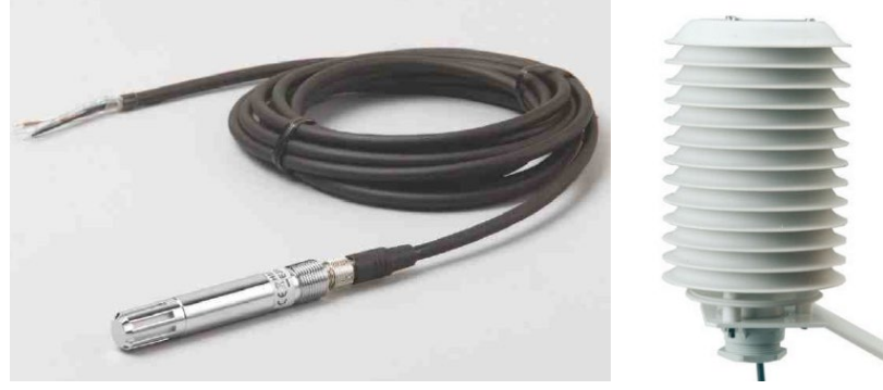
Şekil 3.4. HMP60 Vaisala sıcaklık-nem sensörü ve sıcaklık kalkanı
