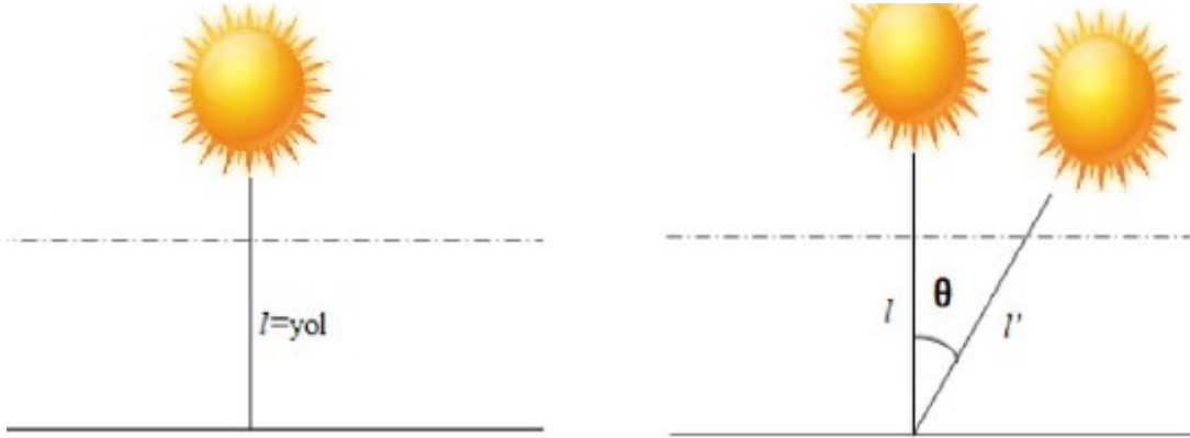
Şekil 2.8. Güneşten gelen ışınların havakürede aldıkları yollar
