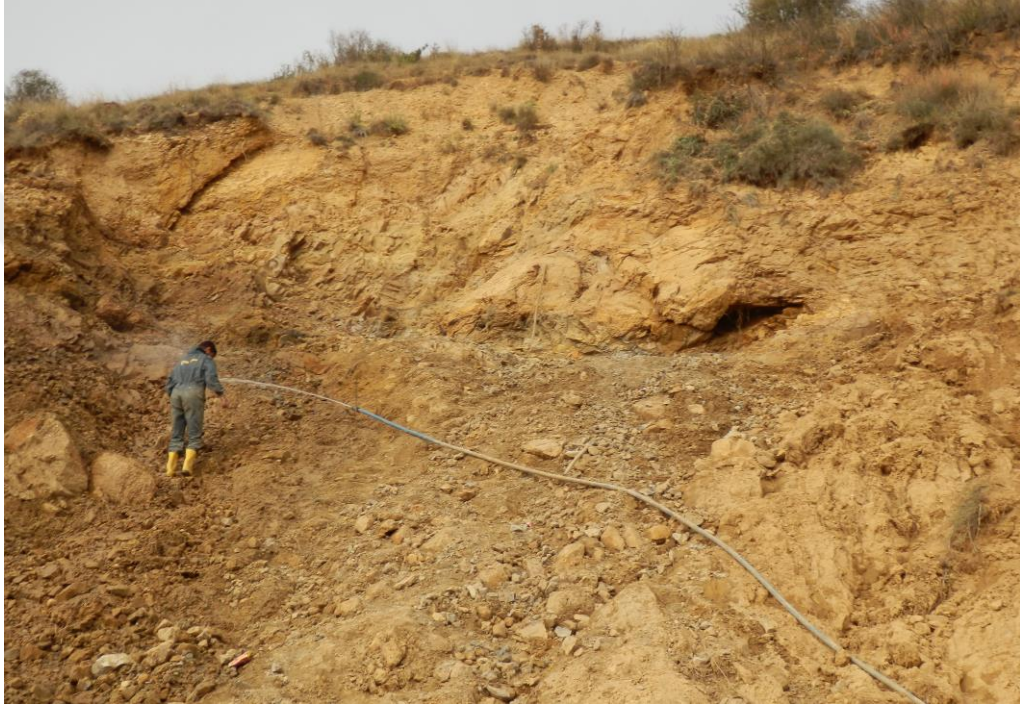
Şekil 5.4 Basınçlı su ile yapılan kehribar madenciliği (Kişisel arşiv, 2018)
