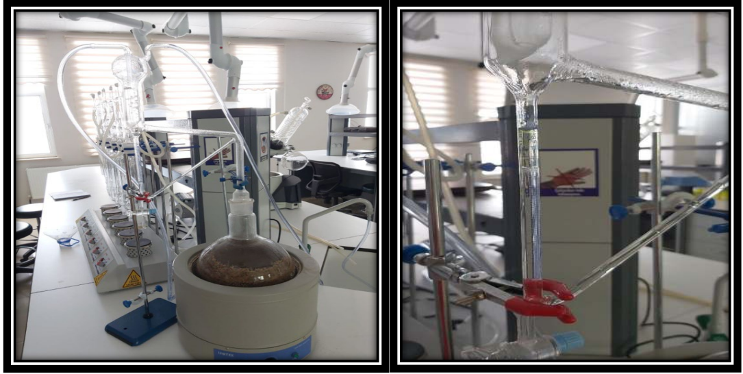
Şekil 9: Deneme Alanında Yetiştirilen, Farklı Dozlarda Mikrobiyal Gübre Uygulanan Lavanta Örneklerinden Uçucu Yağın Elde Edilmesi
