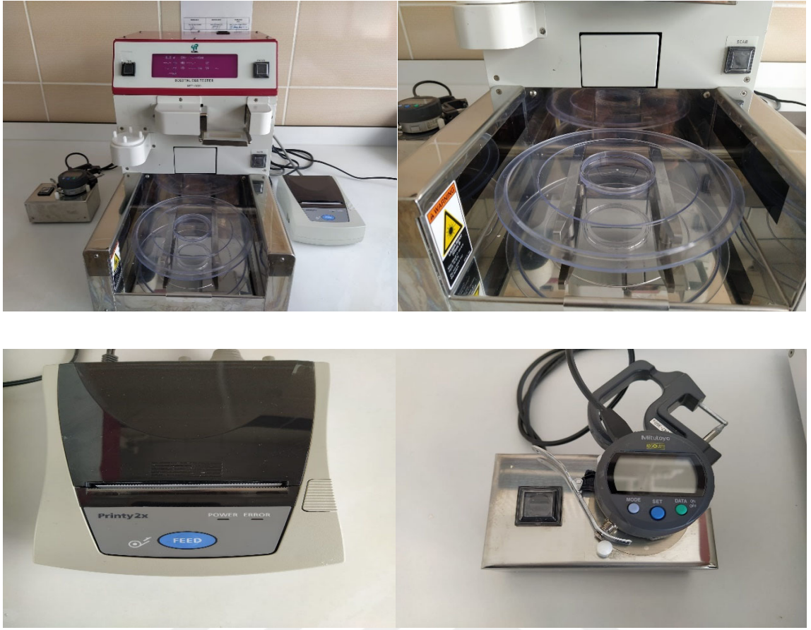
Şekil 21. Yumurta dış kalite analizinde kullanılan dijital yumurta analiz cihazı.
