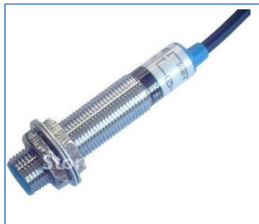
Şekil 3.26. Endüktif sensörün görünümü[13].
