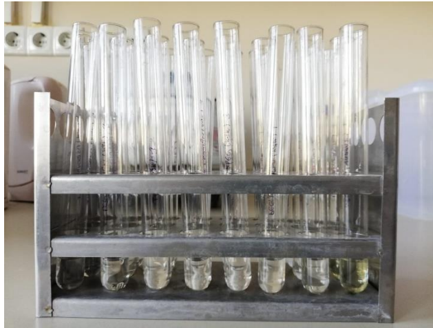
Şekil 3.20. LOX miktarının belirlenmesi için örneklerin son hazırlık aşaması
