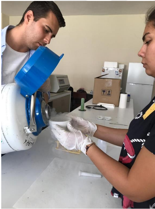
Şekil 3.13. Yaş yaprak ve kök örneklerinin sıvı azot ile parçalanması
