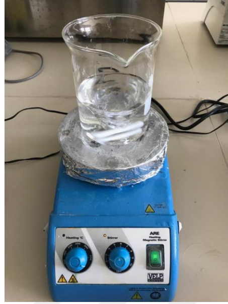
Şekil 3.12. Ekstraksiyon karıştırma aşaması
