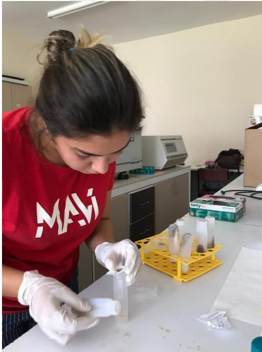
Şekil 3.15. Sentrifüj edilen örneklerin miracloth bezi ile süzülüp süpernatant kısmının analiz için ayrılması
