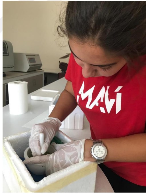
Şekil 3.13. Yaş yaprak ve kök örneklerinin sıvı azot ile parçalanması
