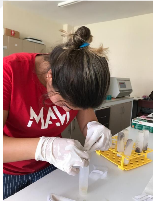
Şekil 3.15. Sentrifüj edilen örneklerin miracloth bezi ile süzülüp süpernatant kısmının analiz için ayrılması
