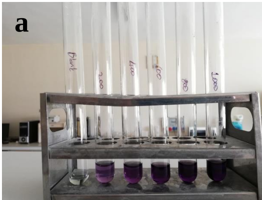
Şekil 3.17. Total protein miktarının belirlenmesi için örneklerin son hazırlık aşaması Protein standartları (a), Protein analizi (b)
