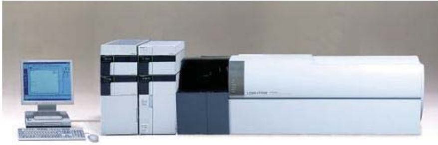
Şekil 2.46. LCMS IT-TOF yüksek çözünürlüklü kütle spektrometresinin fotoğrafı
