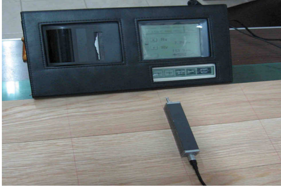
Şekil 24. Yüzey pürüzlülük cihazının genel görünümü
