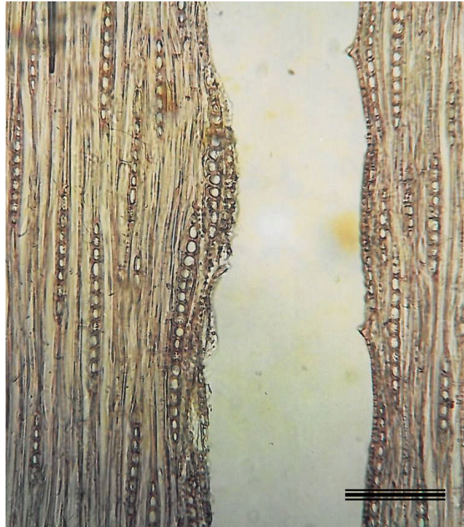
Şekil 35. Anadolu Kestanesi odununun teğet kesitte özışınlarının görünüşü Skala 1=200 \mu m [Foto, Gerçek].
