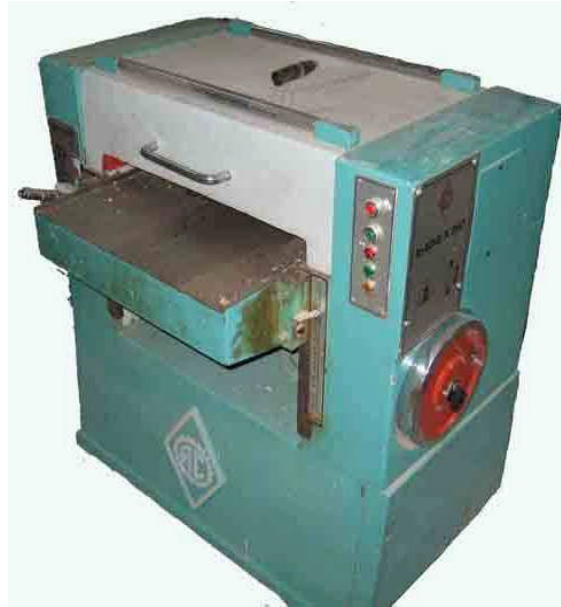
Şekil 22. Kalınlık makinesi (Model AC-K 500)
