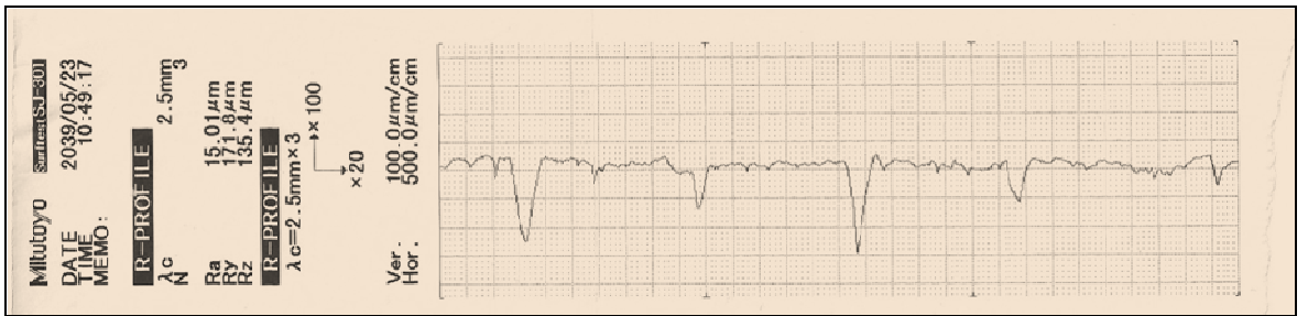
Ek Şekil 7. Anadolu Kestanesi odununda yüksek besleme hızında (16 m/dk) planyalanmış ve 80 no ile zımparalanmış pürüzlülük profili
