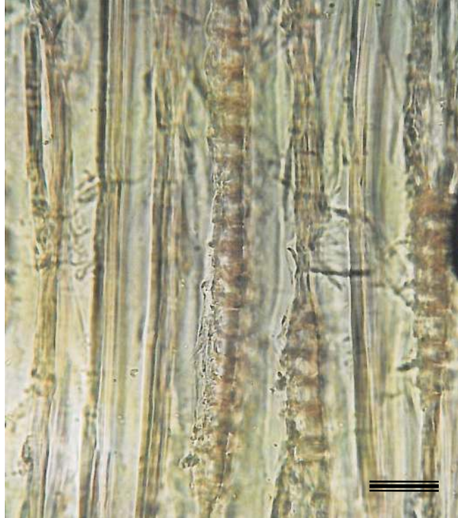
Şekil 38. 80 no’lu zımpara ile işlenmiş Doğu Ladini odununda çok fazla deformasyonlu yüzeyin görünümü Skala 1=225 µm [Foto, Gerçek].
