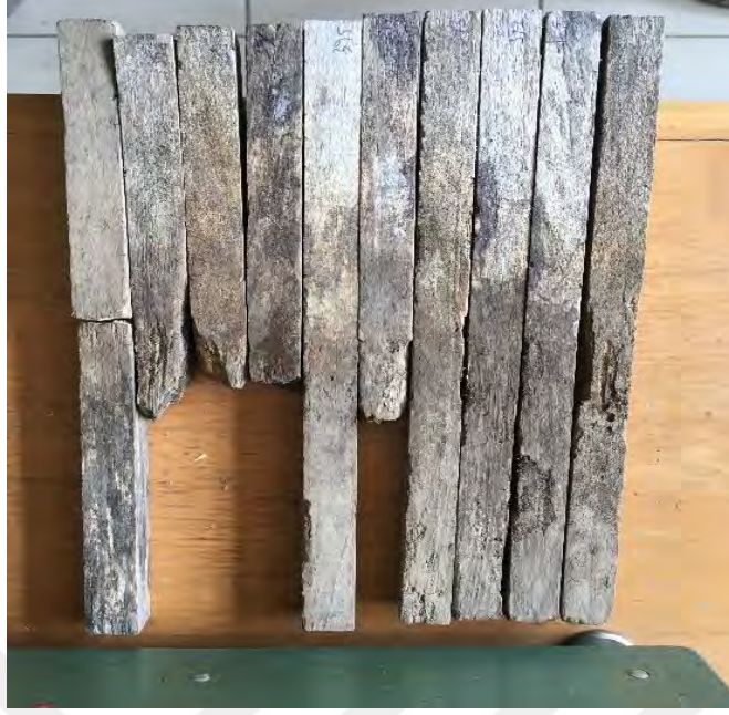
Şekil 75. Mevcut çalışmada emprenyesiz kayın diri odun test örnekleri
