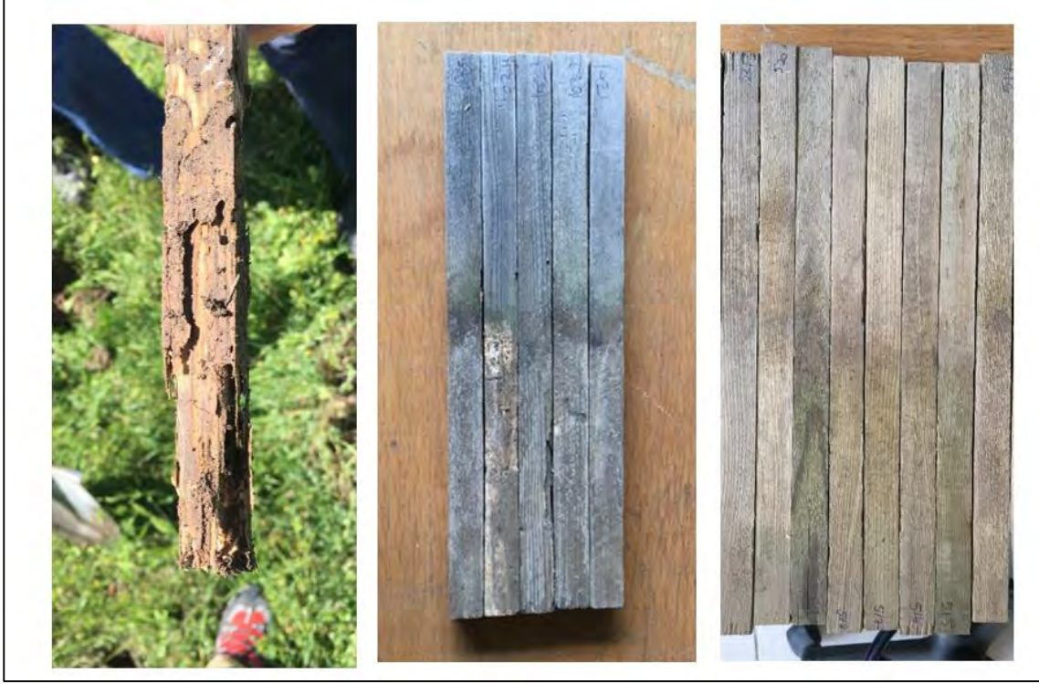
Şekil 30. Çanakkale deneme alanındaki sırasıyla diri odun, öz odun ve emprenyeli diri odun 3. yıl görselleri
