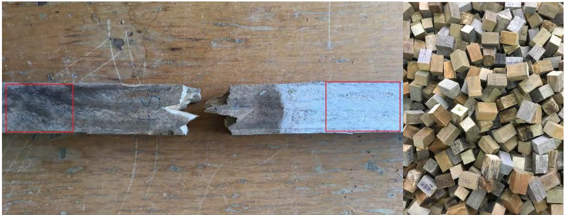
Şekil 18. Liflere paralel basınç direnci test örneklerinin alınması
