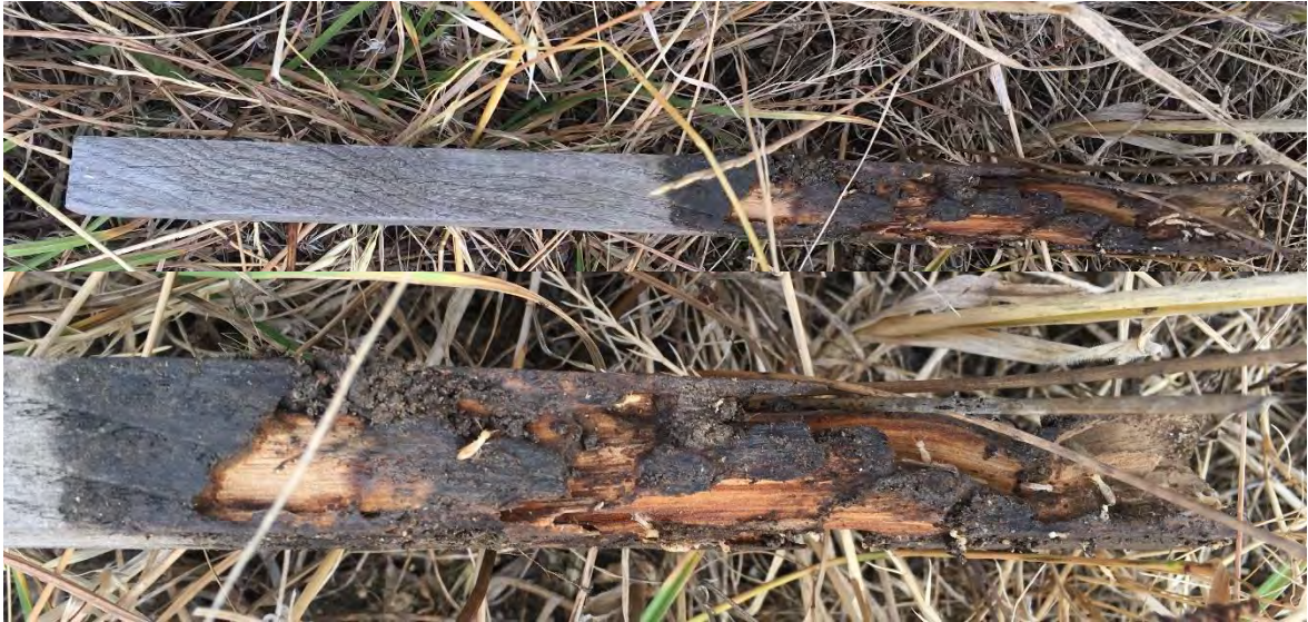
Şekil 35. Çanakkale deneme alanında termit saldırısına uğrayan kestane örnekleri
