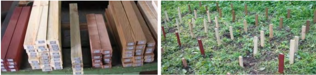
Şekil 6. EN 252 (1989) testi öncesi örneklerin durumu ve arazideki kondisyonları (Knapic vd., 2018)
