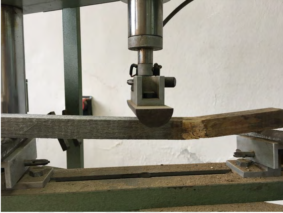
Şekil 72. Çürümenin tam ortadan olmaması ve test sonucunun farklı olabilmesi
