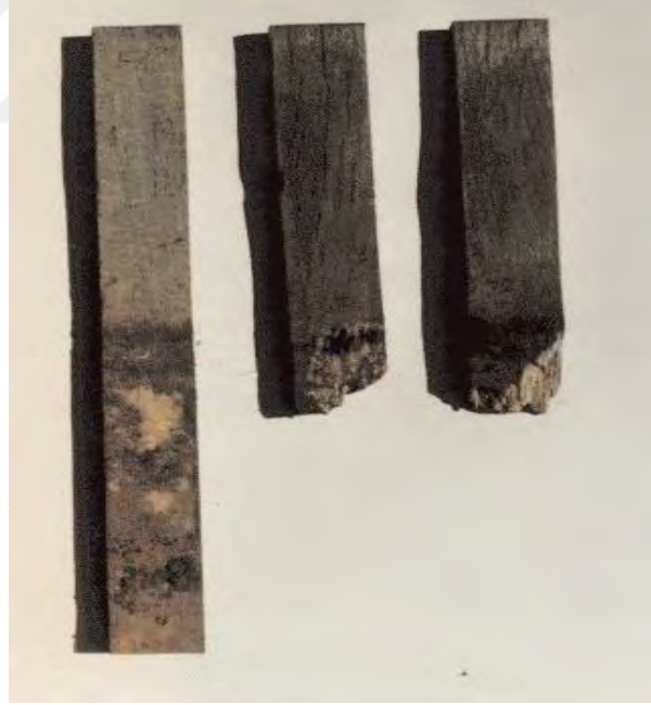
Şekil 76. Yapılan bir çalışmaya ait emprenyesiz kayın diri odun test örnekleri (Zeleniuc vd., 2003)
