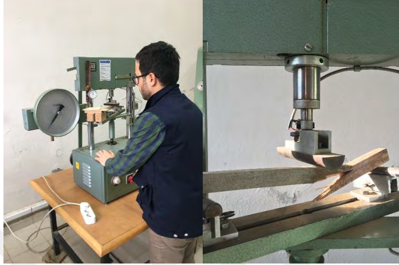
Şekil 16. Örneklerde eğilme direnci ve elastikiyet modülünün belirlenmesi
