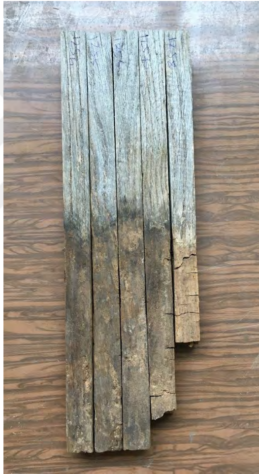
Şekil 46. Ağırlık kaybı daha fazla olan kestane odunu örnekleri
