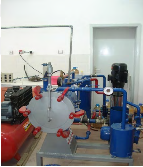
Şekil 9. Laboratuvar tipi silindirik emprenye kazanı
