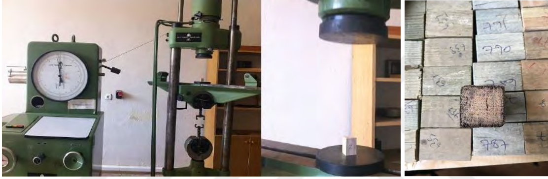
Şekil 19. Liflere paralel basınç direnci test cihazı ve numuneleri
