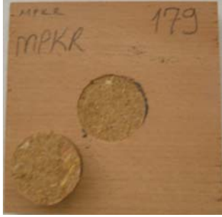
EK-3. (Devam) Yapışma Direnci Deney Sonucunda Bazı Örneklerin Fotoğrafları
