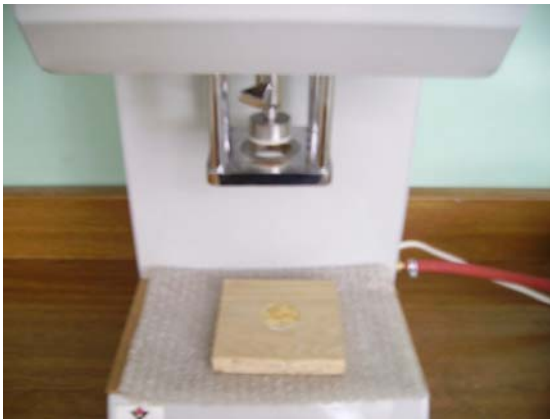
Resim 4.10. Numunenin deney düzeneğinde çekme kuvveti uygulanarak koparılması.
