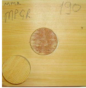
EK-3. (Devam) Yapışma Direnci Deney Sonucunda Bazı Örneklerin Fotoğrafları
