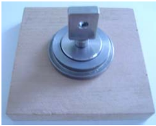
Resim 4.8. Makineye bağlama yarayan pim.
