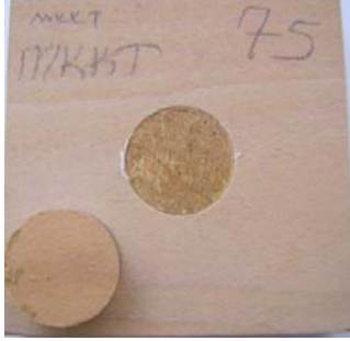
EK-3. (Devam) Yapışma Direnci Deney Sonucunda Bazı Örneklerin Fotoğrafları
