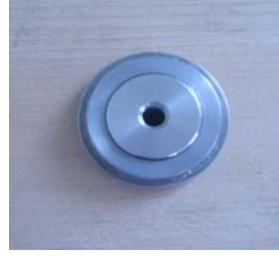
Resim 4.7. Kopmanın sadece silindir altında olabildiğini sağlayan destek bileziği.
