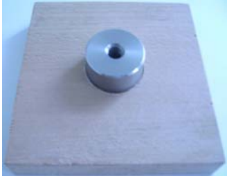
Resim 4.6. Kesici ile taşıyıcı yüzeye kadar kesilmiş deney numunesi
