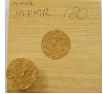
EK-3. (Devam) Yapışma Direnci Deney Sonucunda Bazı Örneklerin Fotoğrafları
