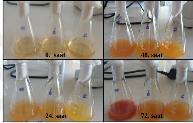
Şekil 4.2. Farklı konsantrasyonda \text{SeO}_2 katkılı süpernatantlar için gözlenen zamana bağlı renk değişim görüntüsü (Soldan sağa: 5,6 mM; 10,71 mM; 15,96 mM)
