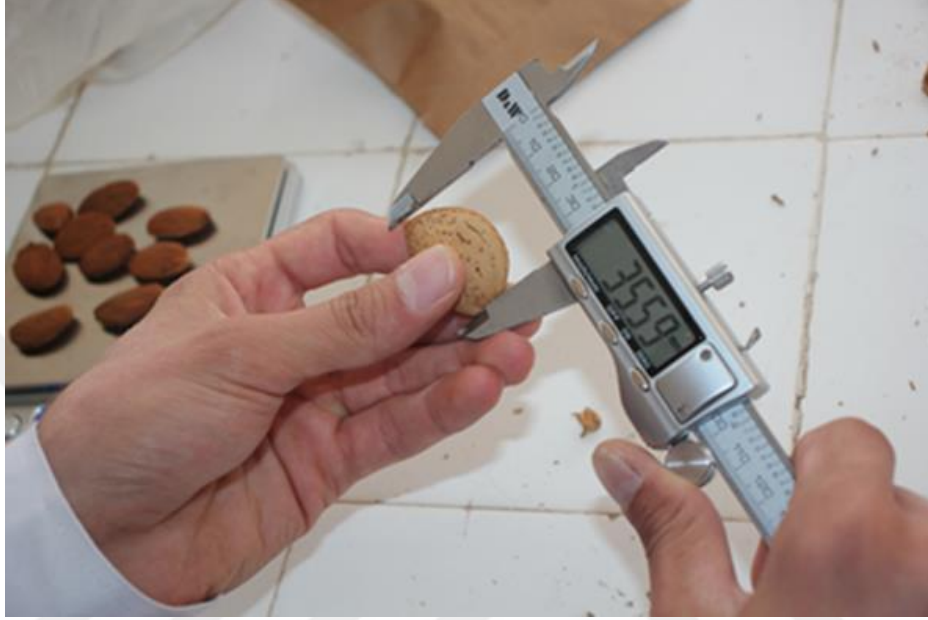
Fotoğraf 3.19. Pomolojik ölçümlerden kabuklu meyve boyunun belirlenmesi
