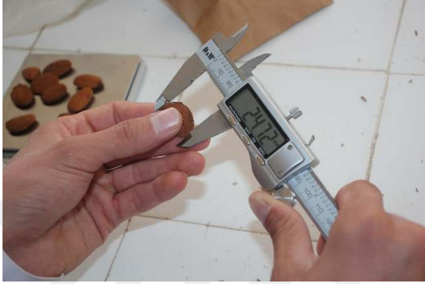
Fotoğraf 3.23. İç badem boyunun kumpas ile ölçülmesi
