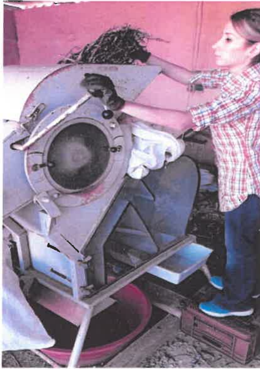
Şekil 3.14. Harman makinesinde daneleme işlemi
