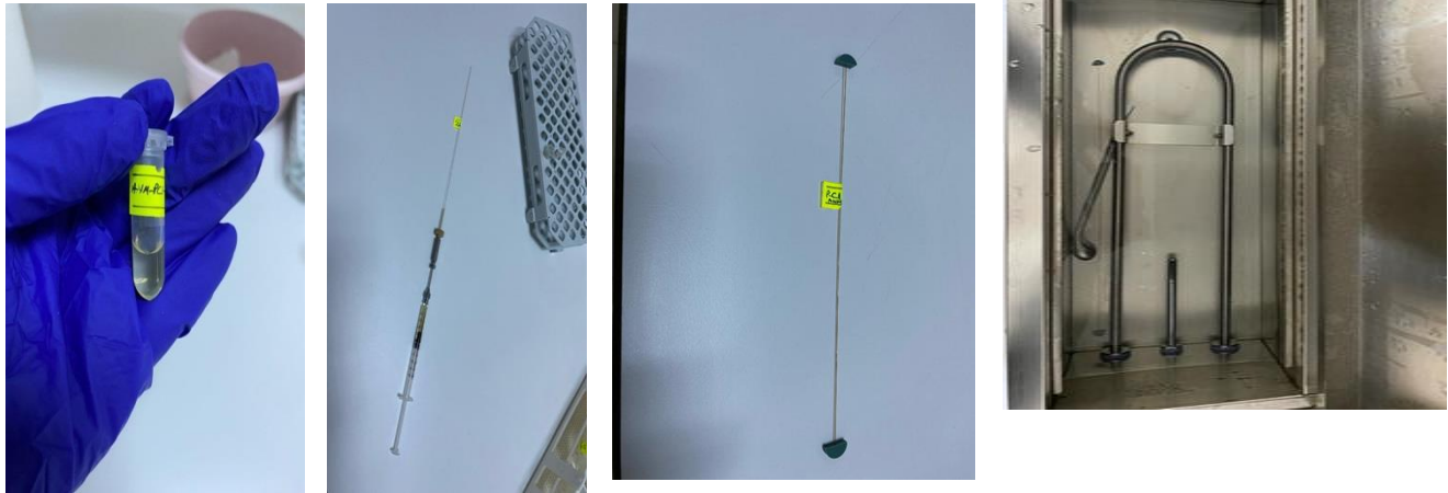
Şekil 4.2. 100 \mu\text{m} iç çaplı 30 cm NMM monolitik kolon sentez aşamaları
