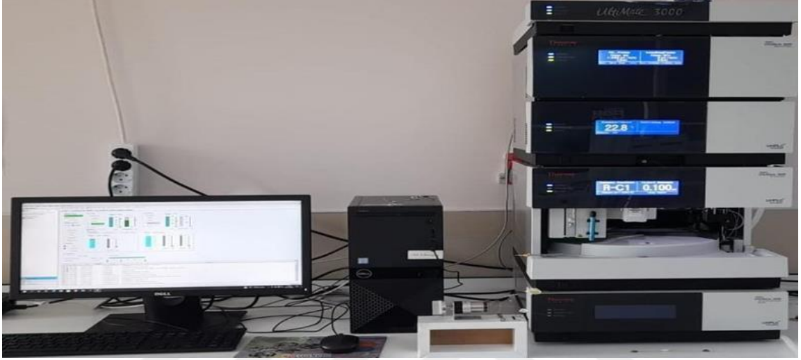
Şekil 2.2. Tez çalışması kapsamında kullanılan Nano-LC sistemi
