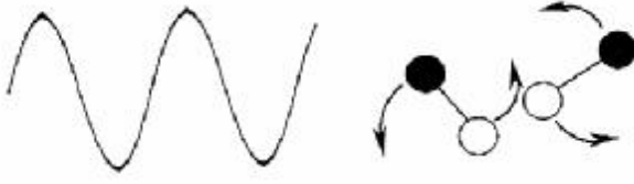
Şekil 1.8. Salınan bir elektrik alan ile düzenlenmeye çalışan dipolar moleküller.
