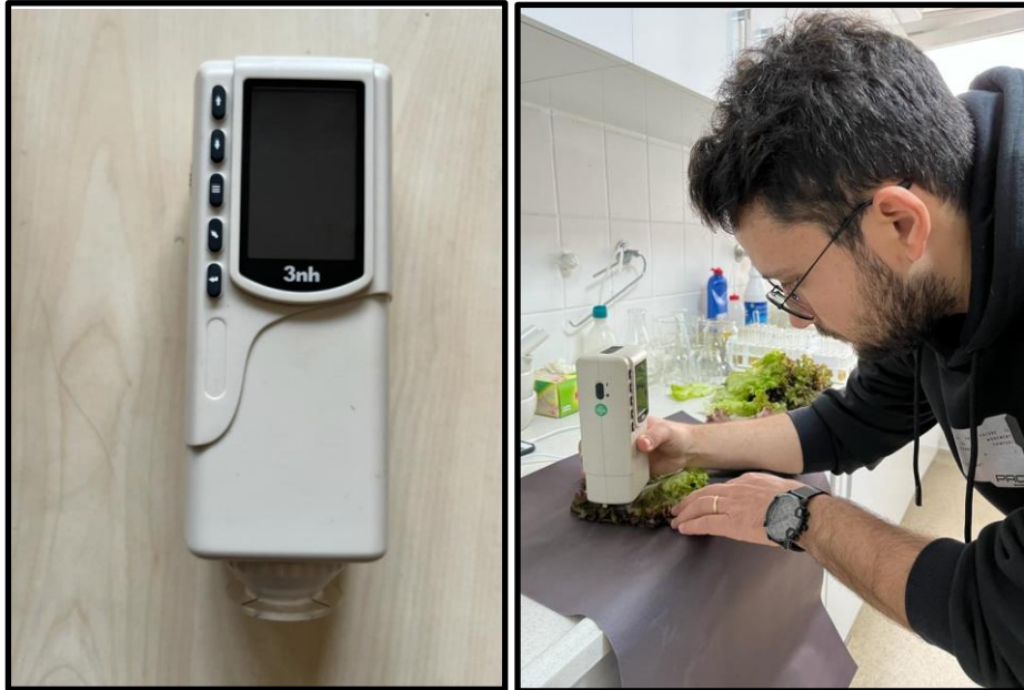
Şekil 3.14. Renk ölçümü yapmak için kullanılan Precision Colorimeter cihazı ve renk ölçümü
