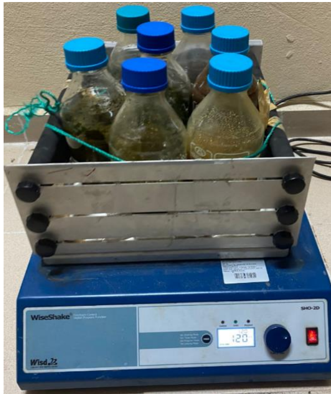
Şekil 3.14. Orbital çalkalayıcıda 24 saat tutulan sıvılar
