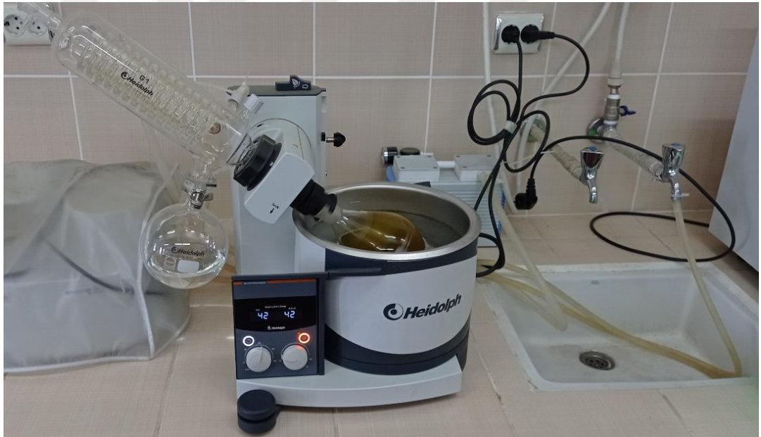
Şekil 3.16. Vakumlu rotary evaporatör yardımı ile yapılan buharlaştırma işlemi
