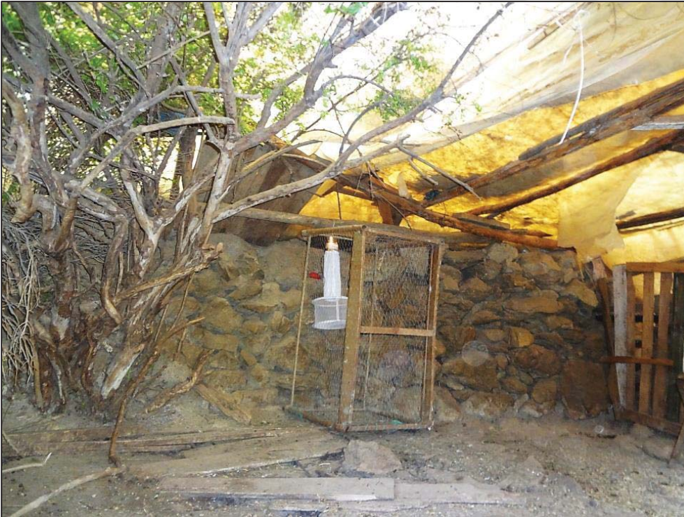
Şekil 3.10. Arazide bulunan hayvanlar tarafından devrilmemesi amacıyla tel kafes içine kurulan ışık tuzağı
