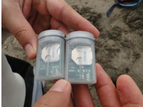
Şekil 3.5. Yuvalara yerleştirilen sıcaklık ölçerler (Fotoğraf: Oğuz Türkozan)
