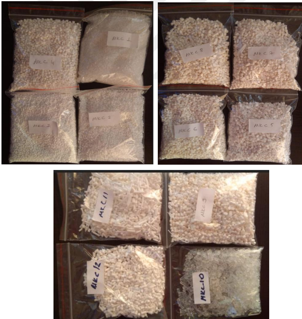
Şekil 7.2. Granür haldeki kompozit numuneler
