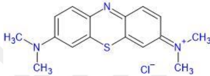
Şekil 1.1. Metil mavisinin kimyasal yapısı [30].
