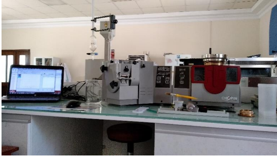
Resim 3.3 Alveograf analiz deęerlerinin belirlenmesinde kullanılan Alveograf cihazı
