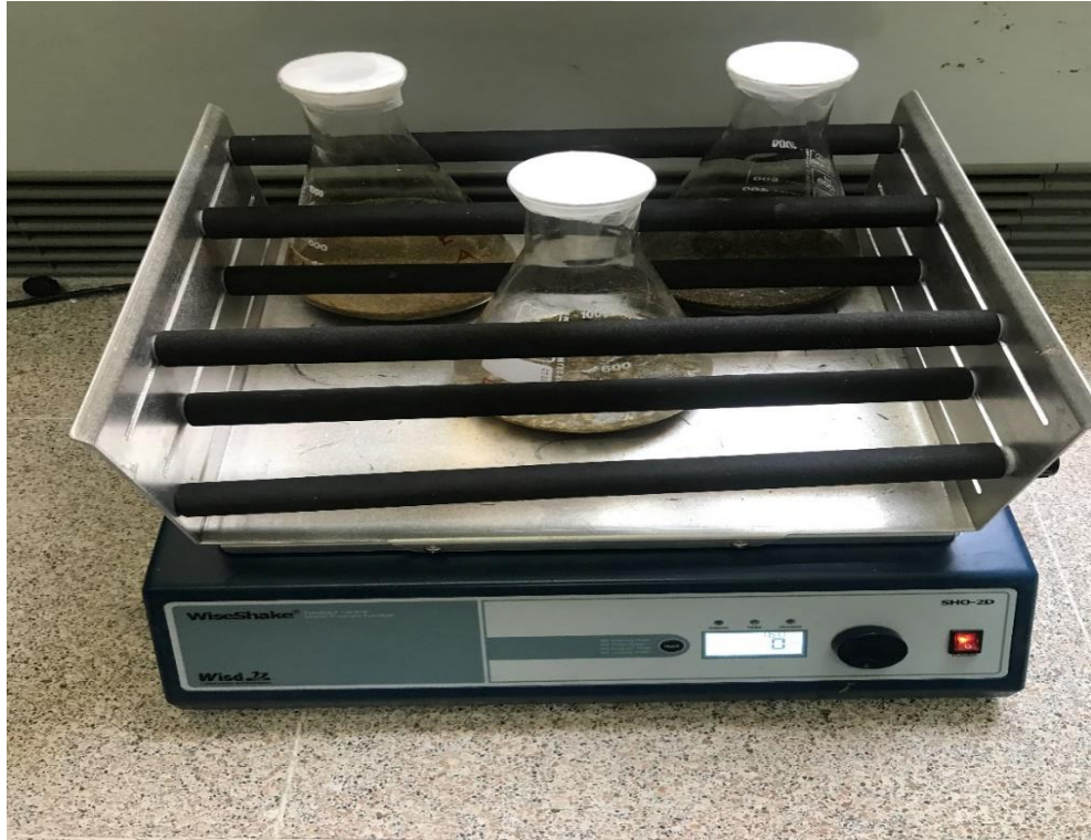
Şekil 3.5 Orbital çalkalayıcıya yerleştirilmiş bitki ekstraktları çalkalama süreci (Kişisel Arşiv, 2021)
