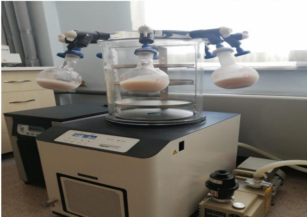
Şekil 3.7 Liyofilizatörden suyun uzaklaştırılması (Kişisel Arşiv, 2021)
