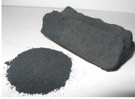
Şekil 1.3. Su filtresinde kullanılmış toz ve blok haldeki aktif karbon
