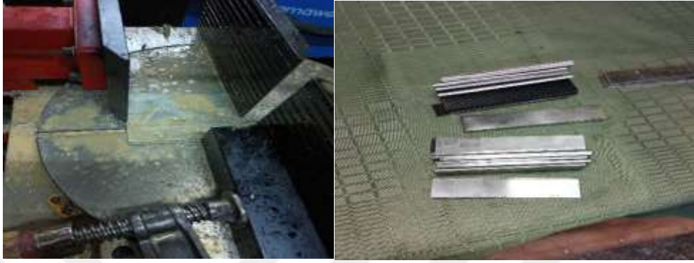
řekil 3.12. Hibrit plakalardan numune ıkarılması; (a) Kesim iřlemi, (b) numuneler
