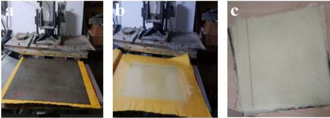
Şekil 3.10. Sıcak preslemeyle plakaların üretilmesi (a) karbon plakaların kürleştirilmesi (b), E-Cam plakaların kürleştirilmesi, (c) plakaların son halleri
