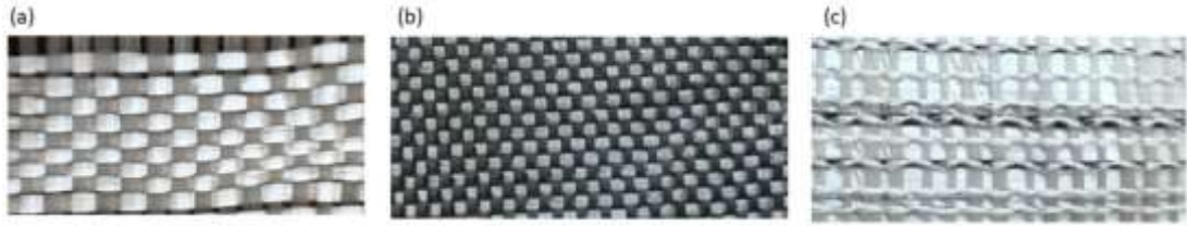
Şekil 3.3. Tez çalışmasında kullanılan (a) 200 g/m 2 plain dokuma E-cam kumaş, (b) 200 g/m 2 plain dokuma karbon kumaş, (c) 330 g/m 2 unidirectional (tekyönlü) E-cam kumaş
