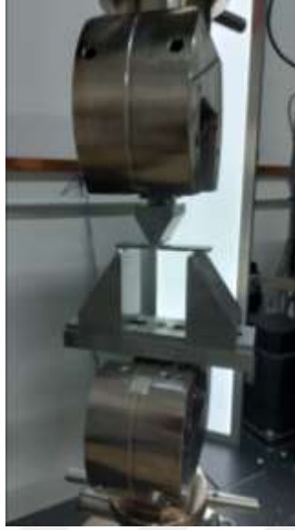
Şekil 4.15. Üç nokta eğme testinden bir görünüş
