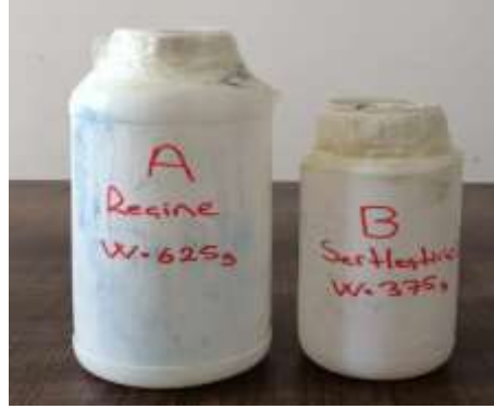
Şekil 3.5. DGEBA bazlı standart bir epoksi reçine ve sertleştiricisi
