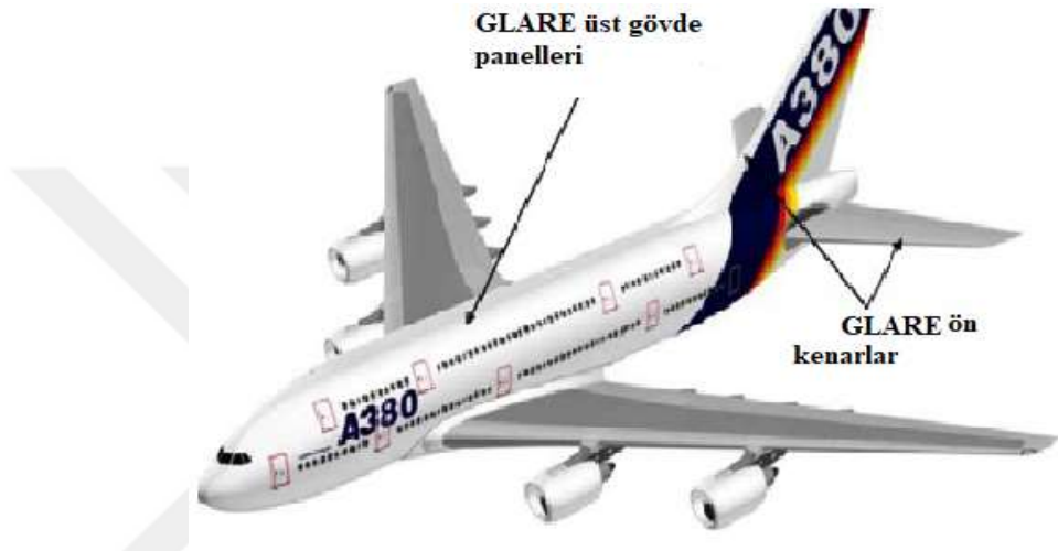
Şekil 2. 3. FML'nin Airbus A380'deki kullanım yerleri (Wanhill, 2017)
