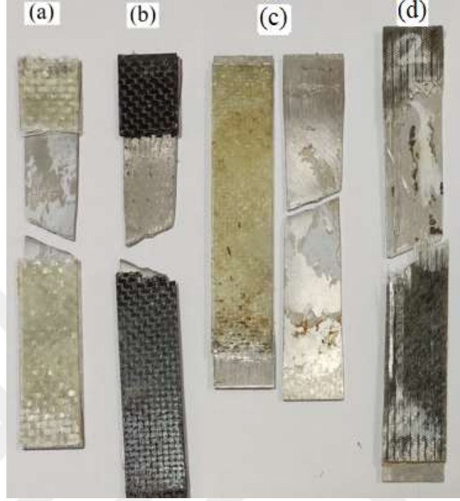
Şekil 4.2. Hasarlı deney numuneleri, (a)E-cam/epoksi/çelik, (b) karbon/epoksi/çelik, (c)alüminyum/epoksi/E-cam/epoksi/alüminyum, (d) E-cam/epoksi/ÇDNKT/alüminyum
