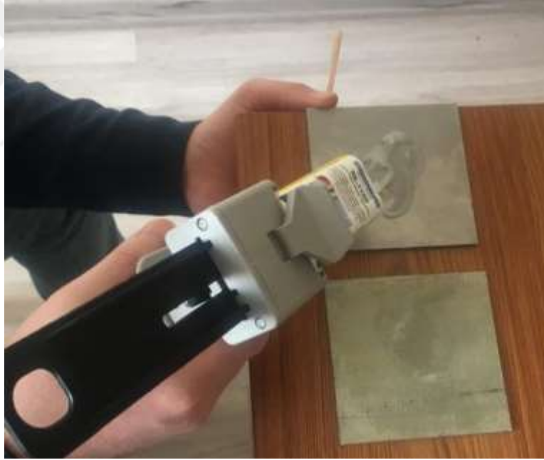
Şekil 3.11. Metal ve kompozit plakaların Weicon RK-7100 ile yapıştırılması
