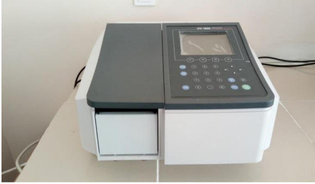
Resim 2.1. UV-GB spektrofotometresi (Orijinal).
