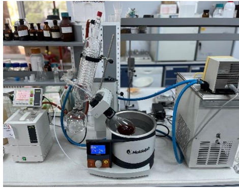
Görsel 3.12. Süzöntülerin rotavaporda (Heidolph) uçurulması işlemi
