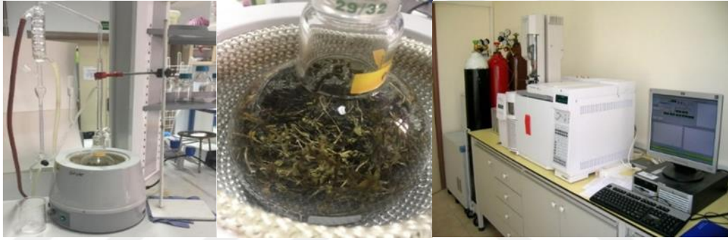
Görsel 3.14. Clevenger apareyi ve GC/MS cihazı
