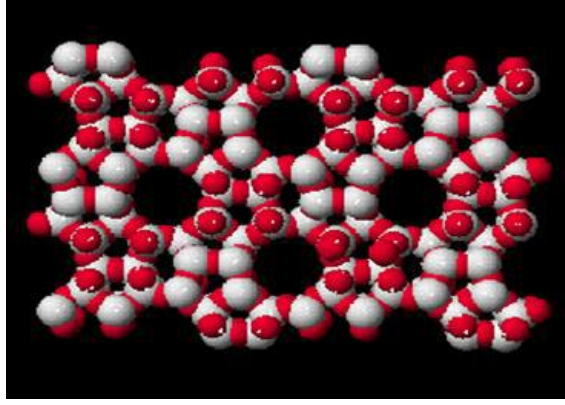
Şekil 2. 26. Zeolitin kafes yapısı (Bozoğlu, 2009)
