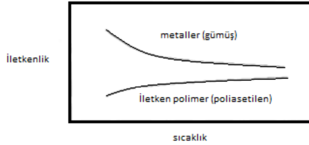
Şekil 2. 5. Sıcaklık ile metallerde ve iletken polimerlerde gerçekleşen iletkenlik değişimi
