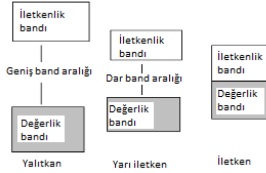
Şekil 2. 4. İletkenlik üzerinde band aralığı etkisi (Saçak, 2002)
