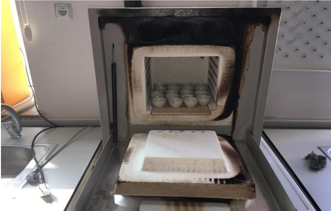
Şekil.3.9. Yem örneklerinin kül yakma fırınında yakılması
