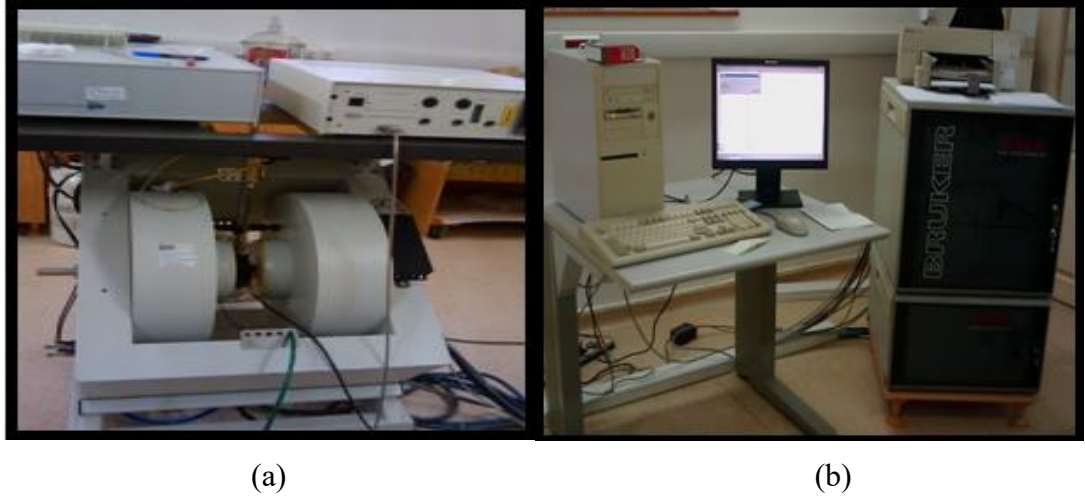
Şekil 3.2 EPR sisteminin genel görünümü a) magnetler b) spektrometre (Bruker EMX EPR Spectrometer- Sürekli dalga X-bandı)
