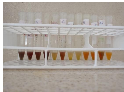
Resim 3.6. Fenolik ve flavonoid madde miktarı tayini için numunelerin hazırlanması
