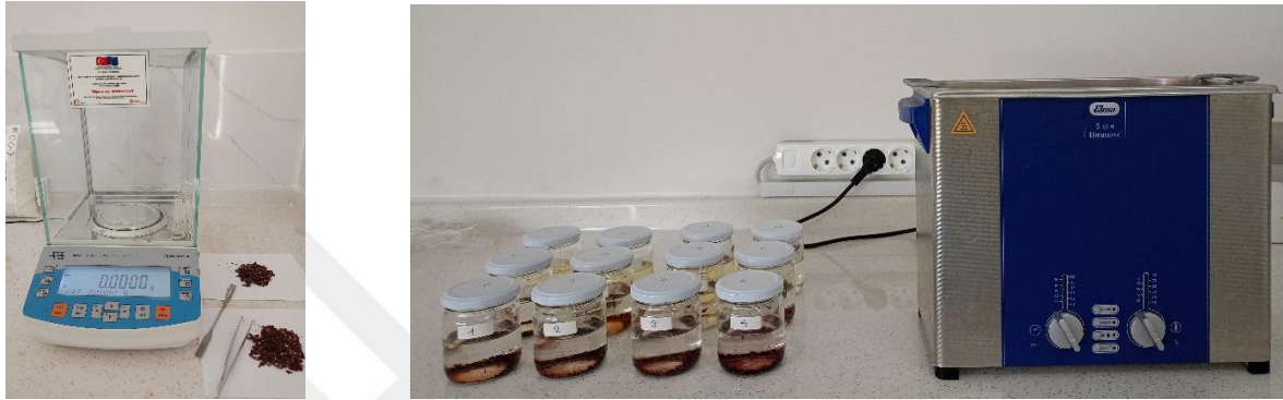
Resim 3.2. Numunelerin tartılması ve numune-metanol karışımının ekstraksiyonu
