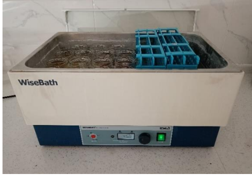
Resim 3.5. Çeker ocak altında su banyosunda metanolün ortamdaki uzaklaştırılması
