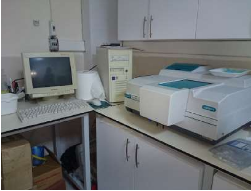
Şekil 3.12. Toplam fenol ve antioksidan aktivitesinin saptanmasında kullanılan spektrofotometre.
