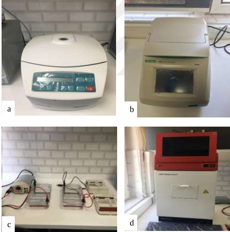
Şekil 3.1. Moleküler çalışmalarda kullanılan cihazlara ait görüntüler; a: Santrifüj cihazı, b: PZR cihazı (Thermal Cycler), c: Agaroz jel elektroforezi, d: UV görüntüleme cihazı.
