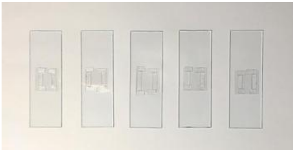
Şekil 4. 1. Faz geçişlerini gözlemlemek için hazırlanan sıvı kristal hücreleri
