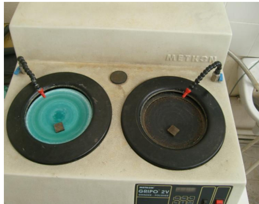
Resim 3.15 Numune parlatma cihazı
