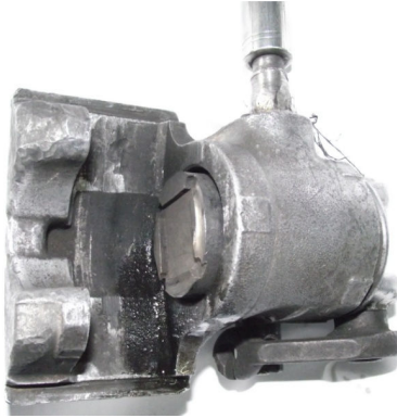
Resim 3.11 Fren balatası test cihazında kullanılan özel olarak yapılmış kaliper pistonu
