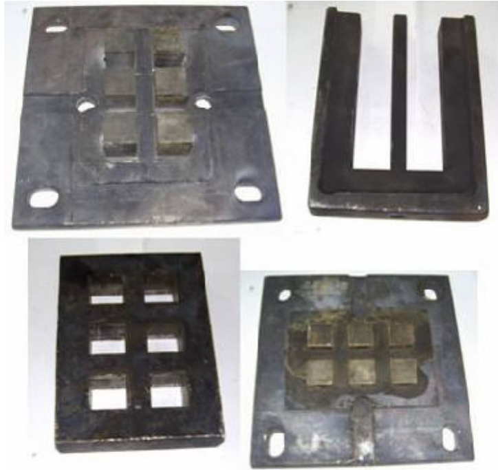
Resim 3.20 Deney numunelerinin üretildiği sıcak presleme kalıbı
