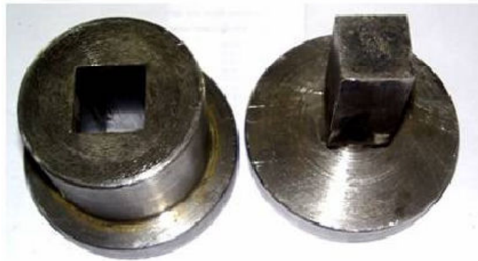
Resim 3.18 Deney numunelerinin üretildiği soğuk presleme kalıbının görünüşü
