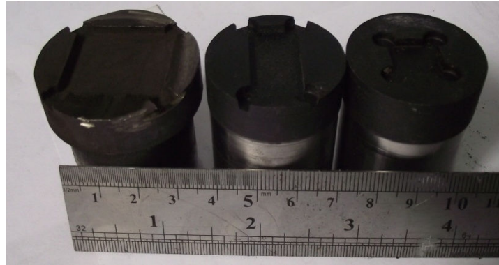
Resim 3.22 1" lik, ½" lik ve ¼" lik balata tutucu pistonlar
