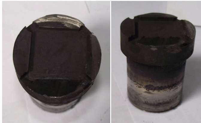
Resim 3.23 1" lik balata tutucu piston
