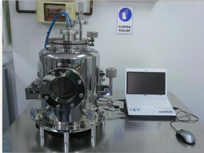
Görsel 3.4. VAKSİS PVD Handy-MT/101T model metal buharlaştırma ve OLED sistemi
