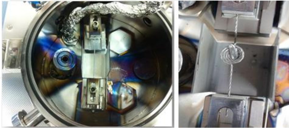
Görsel 3.7.a. Numune odacığının alt kısmında bulunan metal-kaynak kısmı b. Basket pota
