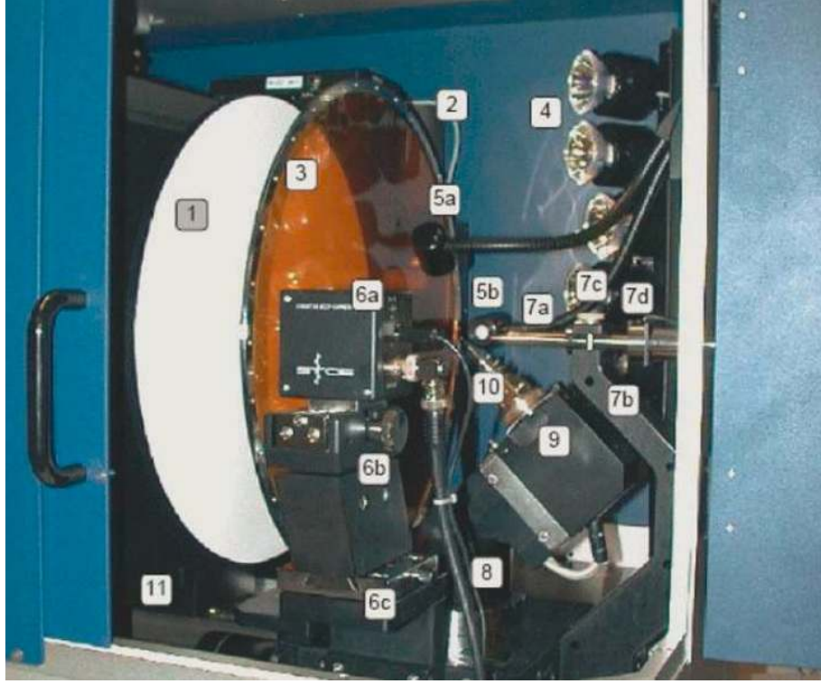
Şekil 2.4 IPDS II kırınım metresinin iç kısmının ayrıntıları: (1) Görüntüleme plakası, (2) Okuyucu kafa, (3) Ana ışın tutucusu, (4) Silici ışıklar, (5a) ve (5b) Örnek aydınlatma lambaları, (6) Video kamera, (6a) Kamerayı hareket ettiren tutucu, (6b) Optik kısım, (7a) Eksenleştirici, (7b) Eksenleştirici tutucusu, (7c) Ek sabitleme vidası, (7d) Güvenlik düğmesi, (8) \omega dönü eksen, (9) \phi eksen-örneği döndüren eğik eksen, (10) Gonyometre başlığı, (11) Görüntüleme plakası taşıyıcısı.
