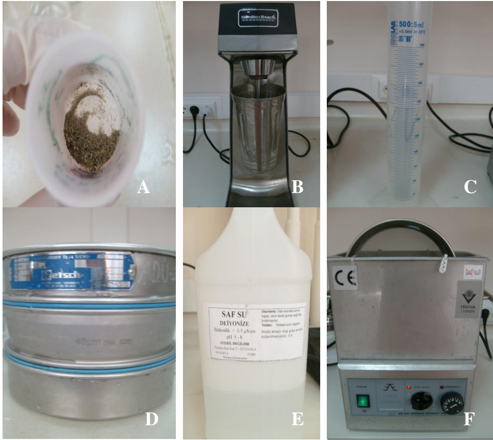
Şekil 3.8. Islak eleme yönteminde kullanılan materyal ve ekipmanlar; A: 1 gr tartılmış saksı toprağı; B: Toprak mikseri; C: 250 ml 0,525% NaOCI; D: 212 \mu m, 45 \mu m' lik elekler; E: Saf su; F: Ultrasonik banyo
