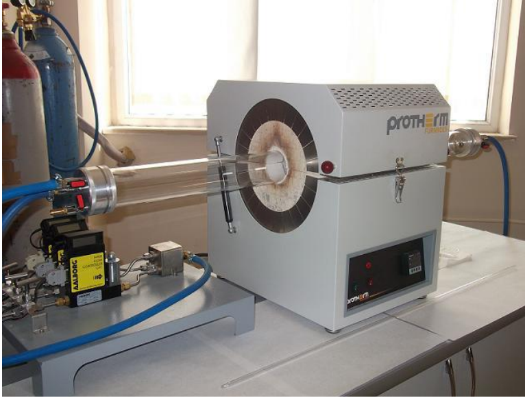
Şekil 3.24. Tavlama işleminin gerçekleştirildiği fırın
