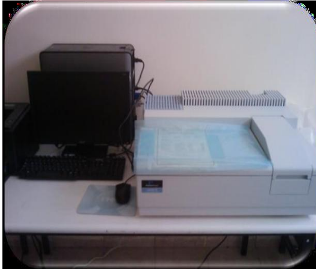
Şekil 3.25. UV-VİS ölçümlerinin yapıldığı Pelkin Elmer lamda-25 fotospektrometre
