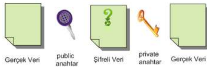
Şekil 1.9. Açık anahtar ile asimetrik şifreleme
